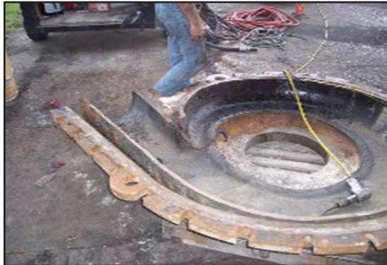
Revestimiento de uretano gastado y dañado.
